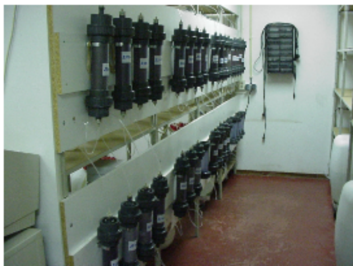
Figuur B1. Kolomproef opstellingen
